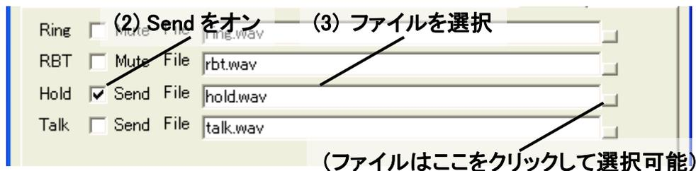
図 36 自己保留方式の送信音声の設定(Sound タブ)
